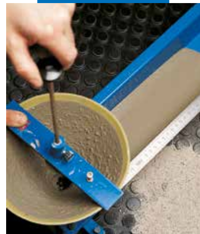
Испытание расширения в канавке согласно норме UNI 8997/89
