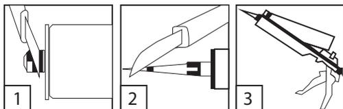
Клей наносят на одну из поверхностей: пятнами (1) — на неровных основаниях, волнистыми полосами (2) — для улучшения фиксации на больших поверхностях или прямыми полосами (3) — на поверхностях с небольшой площадью.
